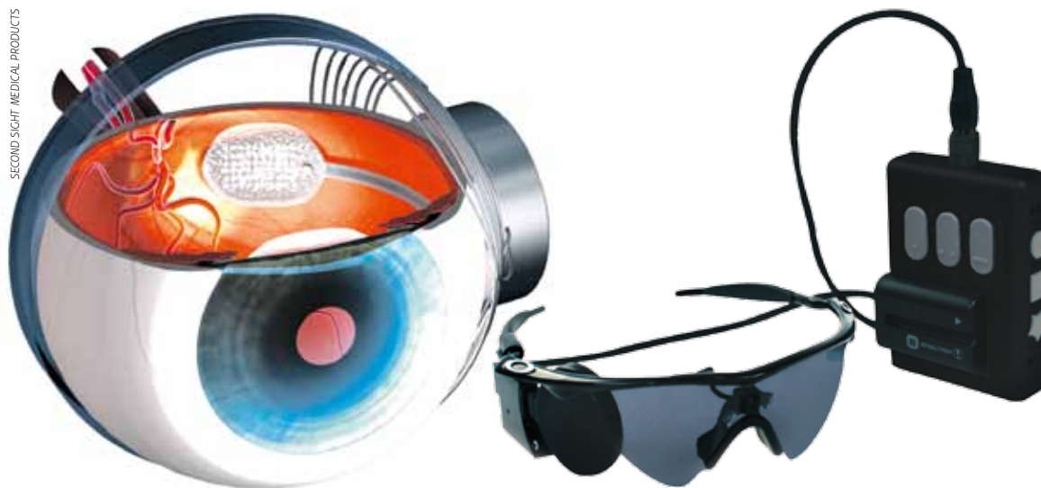
À gauche, un implant rétinien «Argus II»; à droite, des lunettes avec caméra intégrée et VPU (Video Processing Unit).
